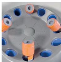
3. Coloque os tubos na centrífuga
